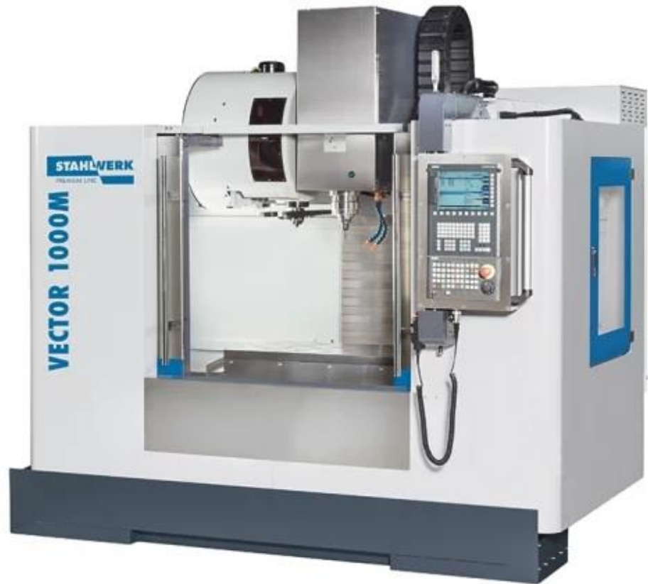
Vector 1000 M с ЧПУ Siemens Sinumerik 828D
