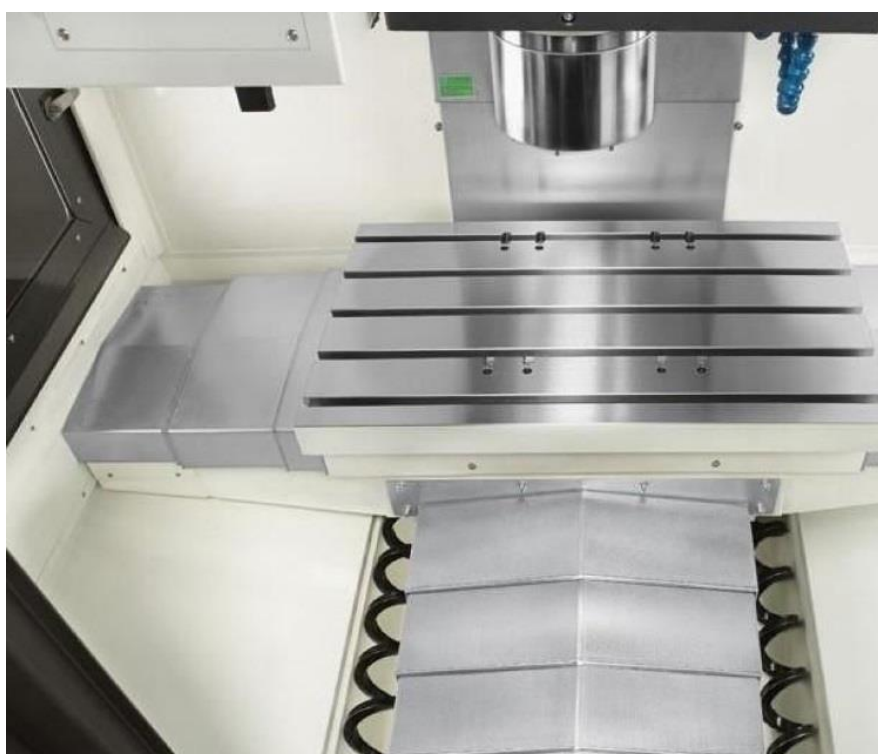
Рис. 1.6 – Зовнішній вигляд фрезерного верстата з ЧПК KИTAMURA MYCENTER - 2XD SPARKCHANGER 15Y (a) та його робоча зона (б)
