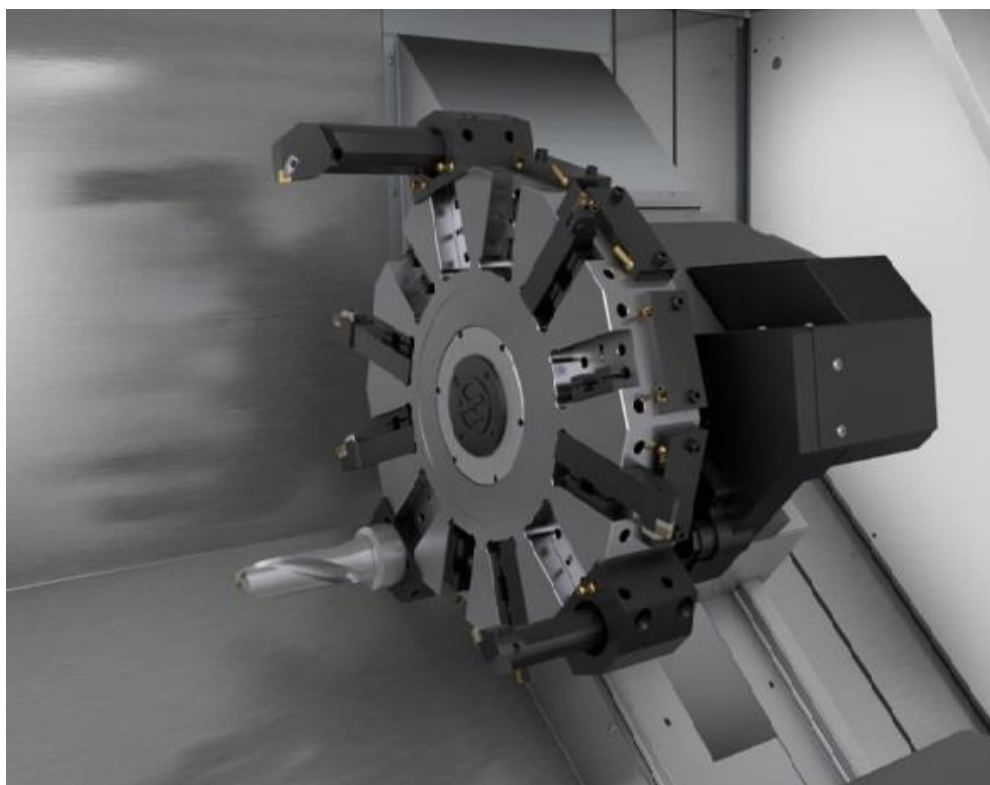
Рис. 1.5 – Зовнішній вигляд токарного верстата з ЧПК HAAS ST-15Y (а) та його револьверна головка (б)
