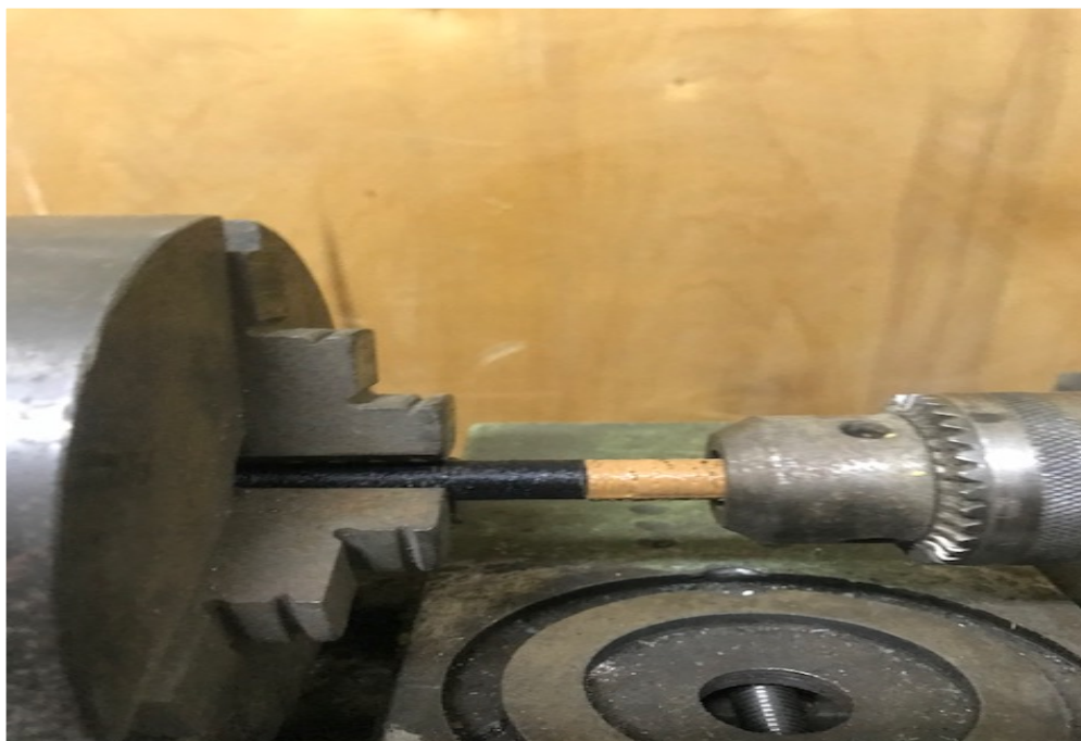
Рисунок 3. 7 – Процес зварювання на експериментальній установці
