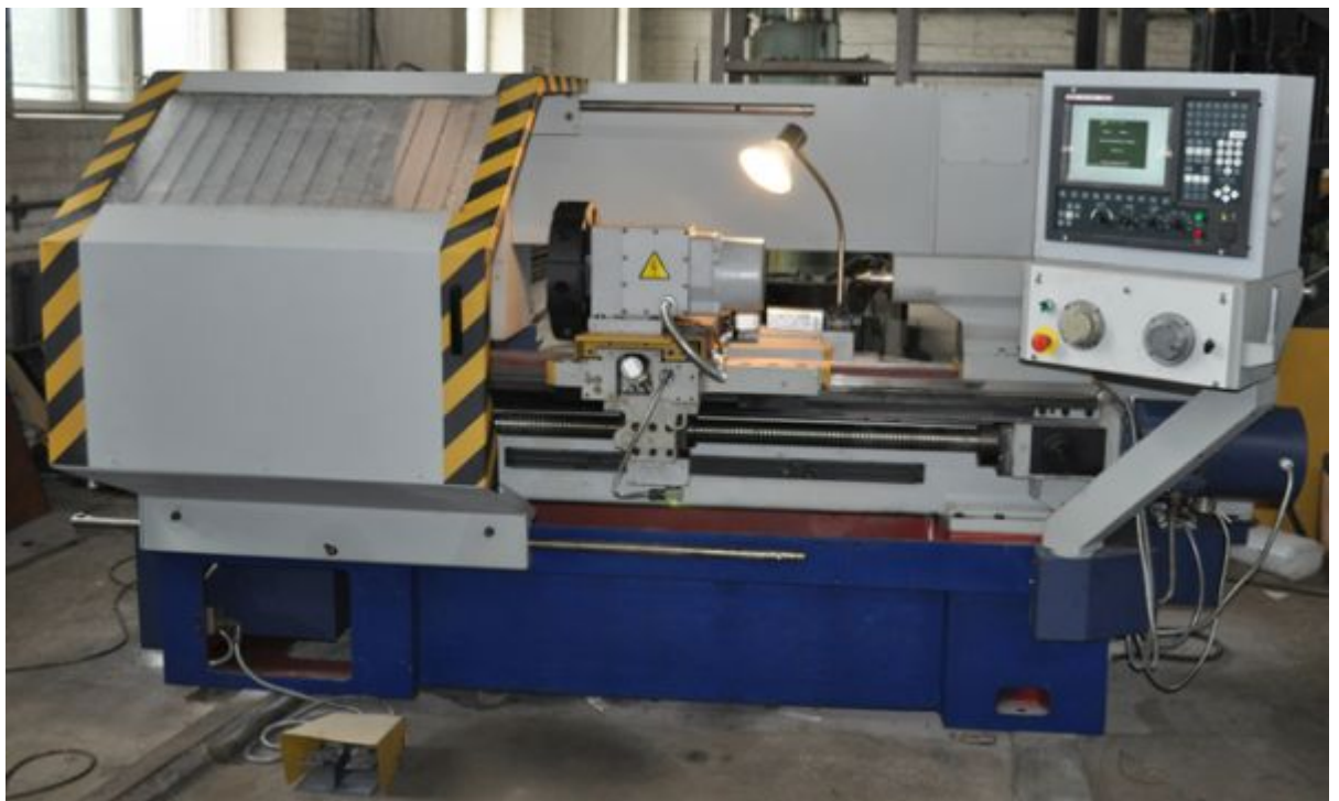
Рис. 2.2 Токарно-гвинторізний верстат 16К20Ф3С5
