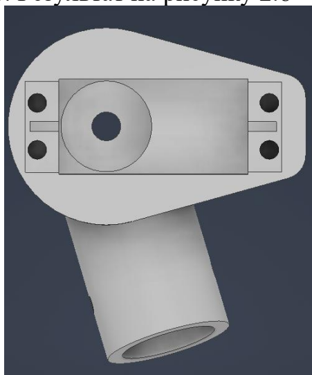
Рисунок 2.8 – зменшений отвір під ось обертання
