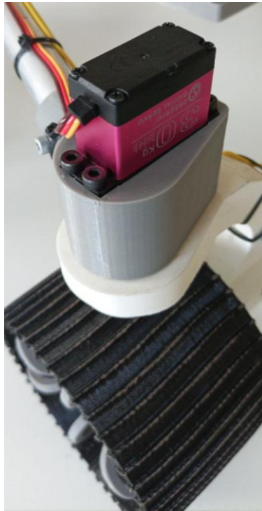
Рисунок 3.12 – серводвигун DS3230 встановлений на марсоході
