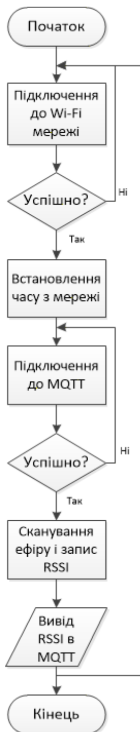
Рисунок 3.2 – Блок-схема алгоритму сканування Bluetooth ефіру ESP32
