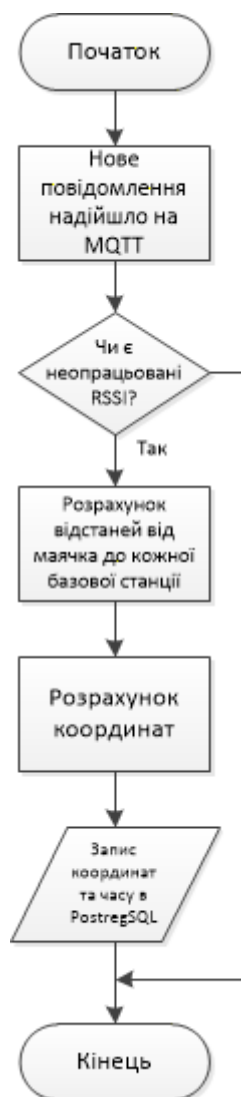
Рисунок 3.3 – Блок-схема алгоритму розрахунку координат
