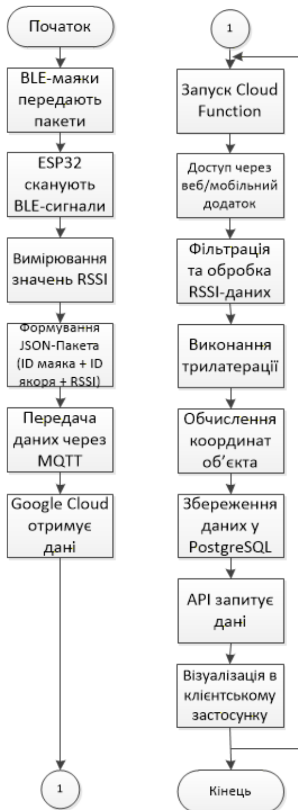
Рисунок 2.9 – Блок-схема алгоритму роботи системи
