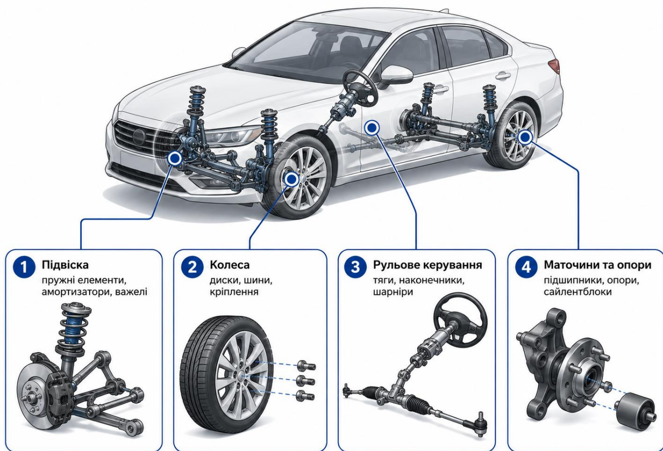
Рисунок 5.1 – Склад основних елементів ходової частини легкового автомобіля
