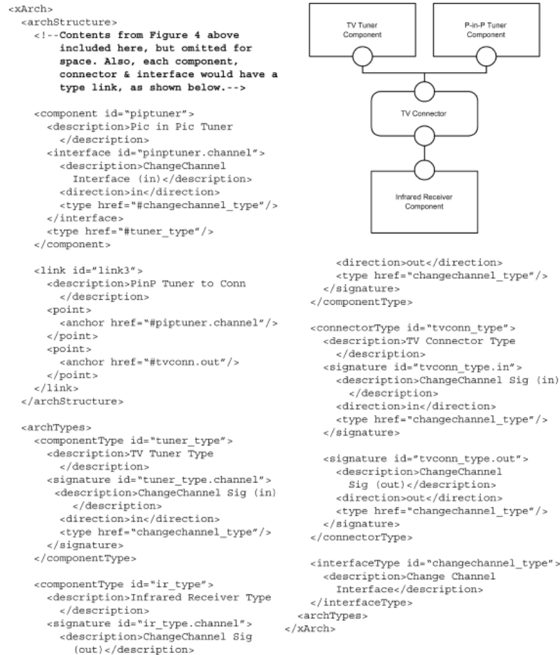
Рисунок 2.5 - Діаграма розширеної версії прикладу телевізійної архітектури з додаванням компонента «картинка в картинці» та доповненнями до нашого попереднього опису xADL 2.0
