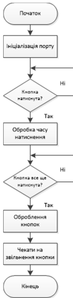
Рисунок 2.17 – Блок-схема алгоритму розпізнавання кнопок
