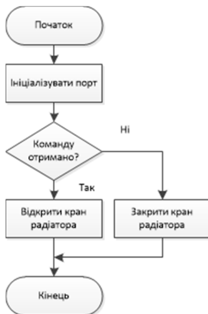
Рисунок 2.16 – Блок-схема алгоритму керування сервоприводом
