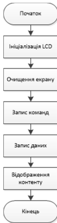
Рисунок 2.13 – Блок-схема алгоритму керування OLED LCD
