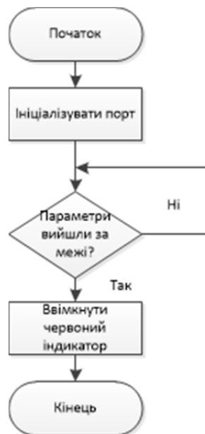
Рисунок 2.18 – Блок-схема алгоритму керування LED-індикаторами
