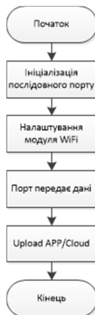
Рисунок 2.14 – Блок-схема алгоритму роботи модуля ESP8266
