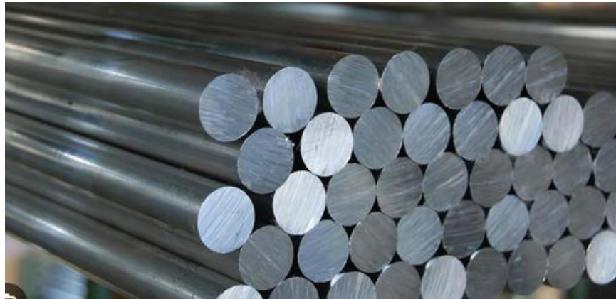
Рисунок 2.2 – Сталь Х12МФ згідно з ГОСТ 5950–2000
