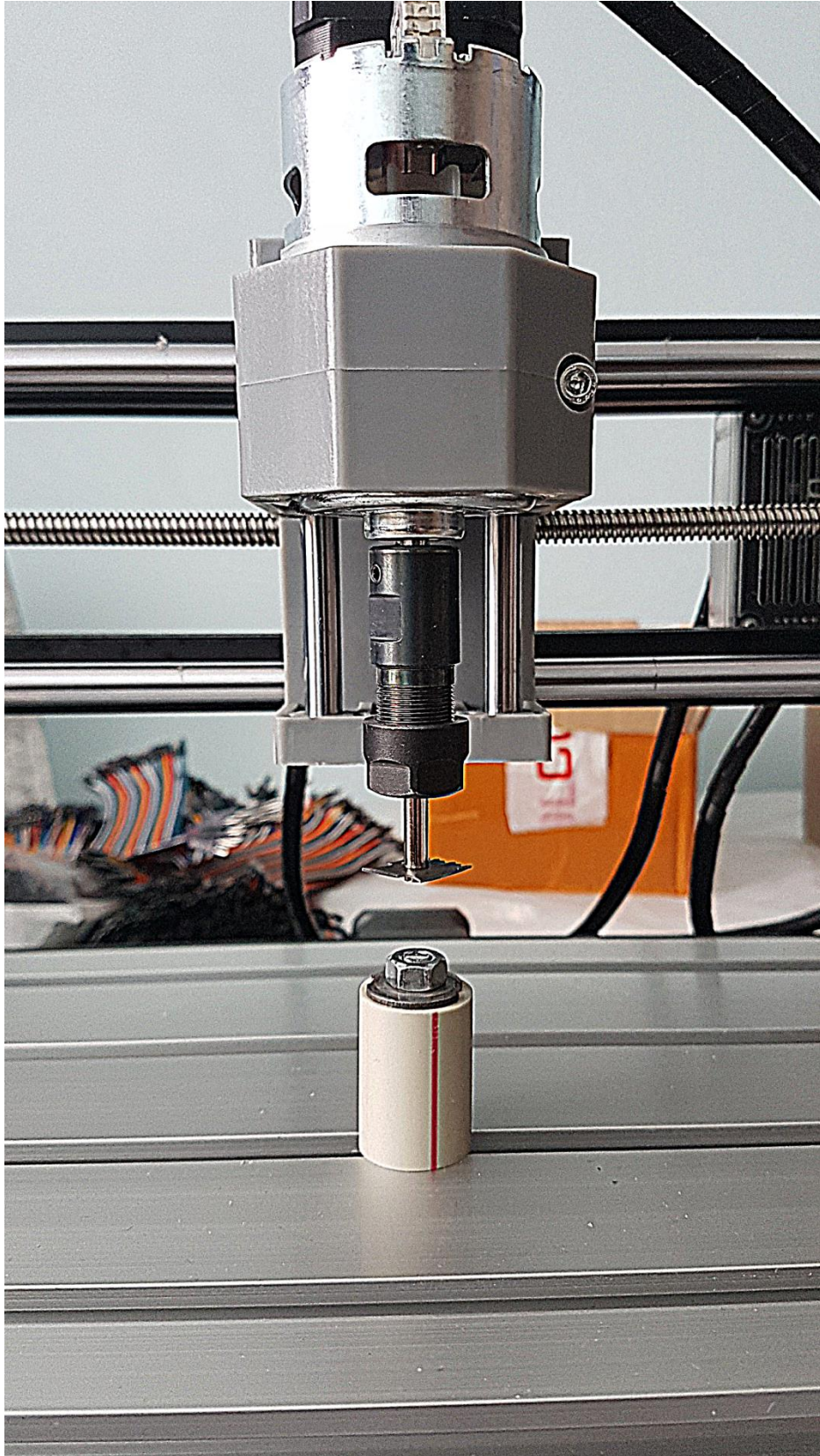
Рисунок 3.6 - Заготовка, закріплена на верстаті CNC 3018 Pro
