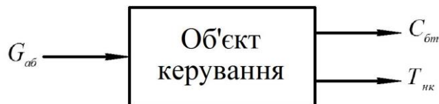
Рисунок 2.1 - Зображення керуючих і збурюючих впливів на стабілізаційну колону
