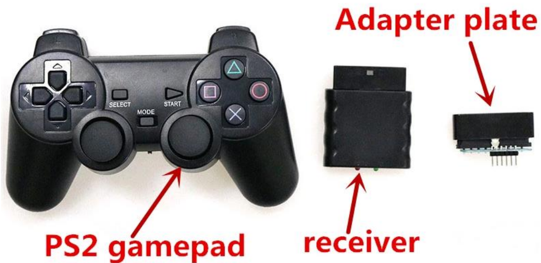
Рис. 3.5 – Радіоприймач, Bluetooth адаптер та геймпад від Play Station 2.
