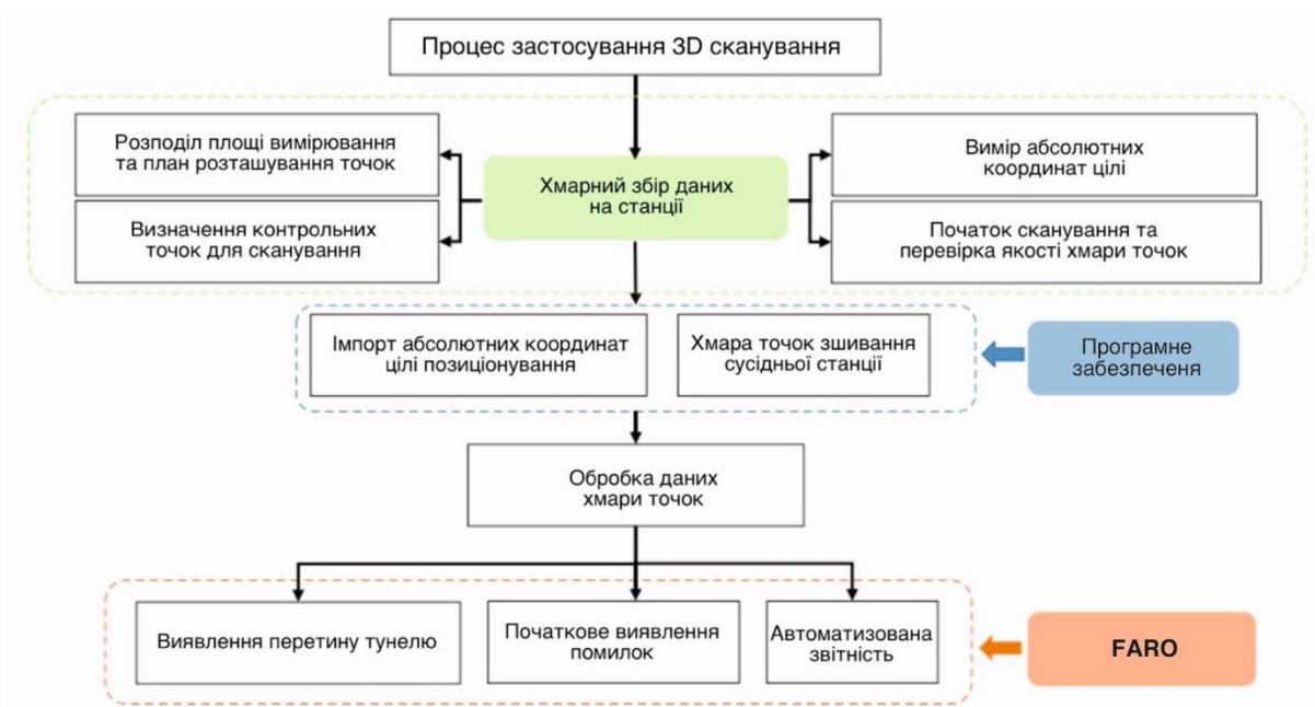
Рисунок 4: Процес застосування 3D лазерного сканування.
