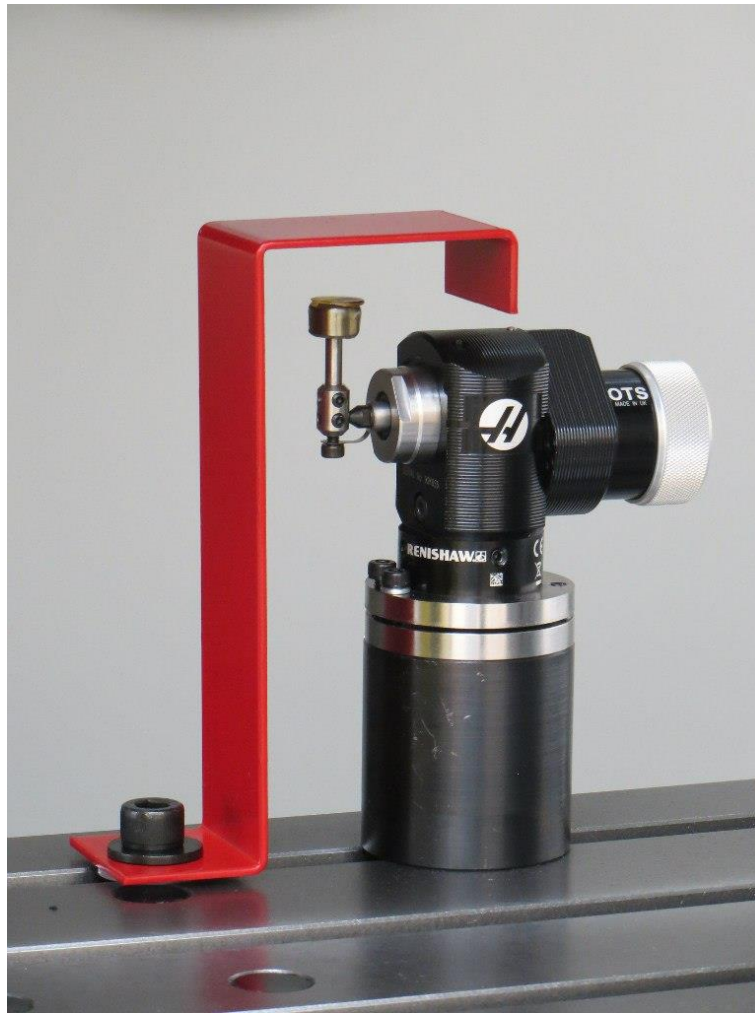
Рисунок 3.6.1- Зображення датчика для налагодження інструменту.
