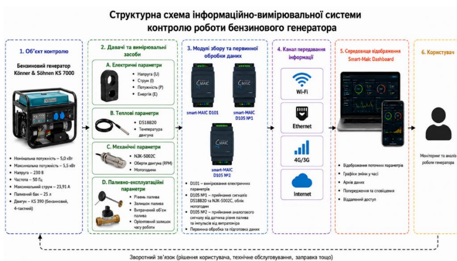
Рисунок 2.1 - Структурна схема інформаційно-вимірювальної системи контролю роботи бензинового генератора
