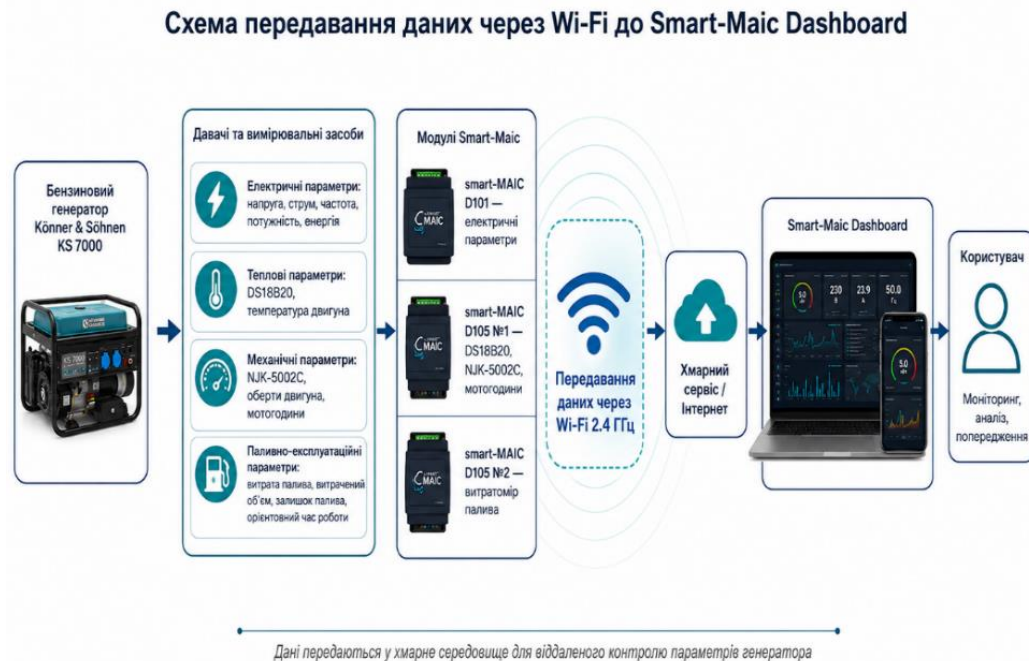
Рисунок 3.2 - Схема передавання даних через Wi-Fi до Smart-Maic Dashboard
