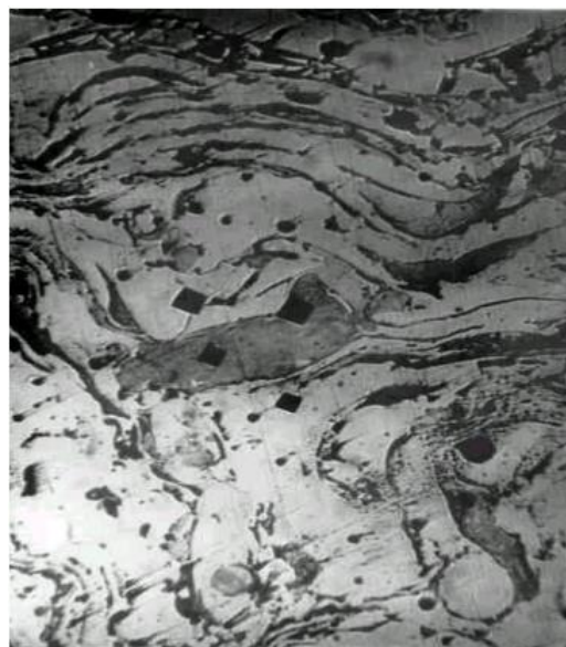
Рисунок 6.4 – Мікроструктура покриття з порошкового дроту [Помилка! Джерело посилання не знайдено.]
