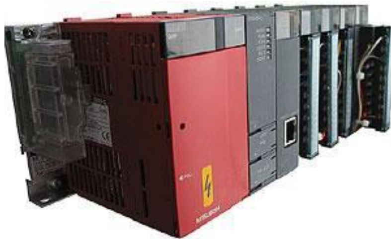
Рисунок 4.6 - Загальний вигляд регулятора «SYSTEM Q Mitsubishi Electric»
