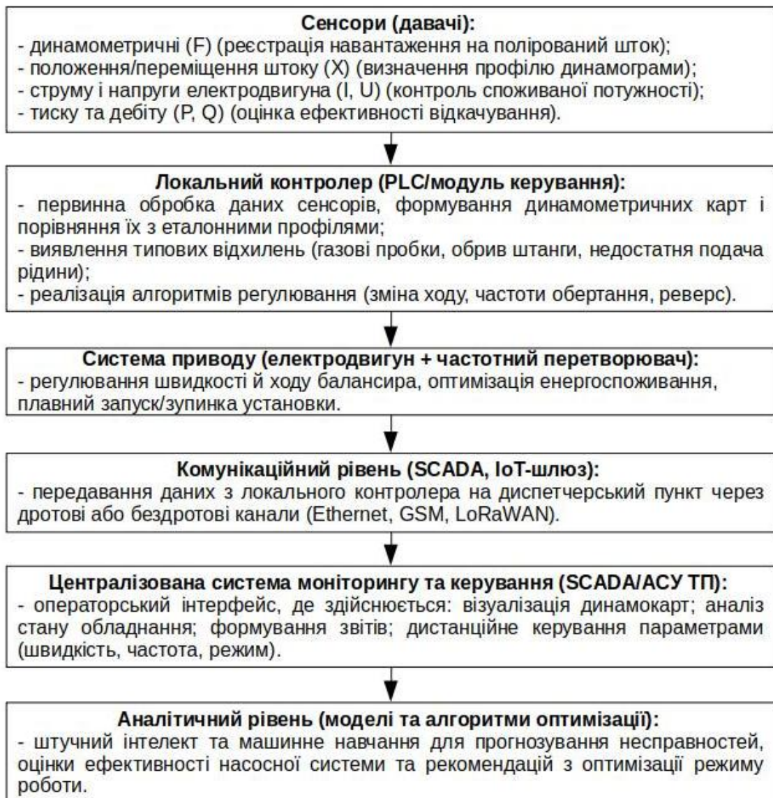
Рисунок 1.2 - Узагальнена структура системи керування ШГНУ
