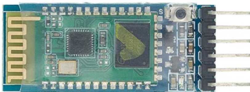
Рисунок 2.14 – Bluetooth модуль HC-05
