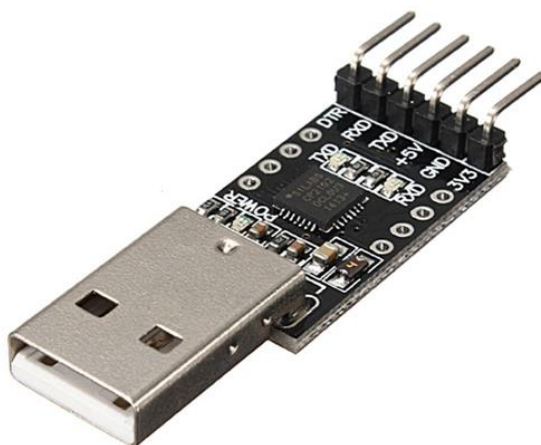
Рисунок 2.18 – Перехідник USB To TTL UART CP2102
