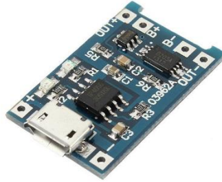
Рисунок 2.9 – Контролер заряду TP4056
