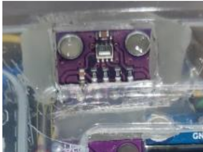
Рисунок 3.3 – Реалізація підключення давача атмосферного тиску BMP280
