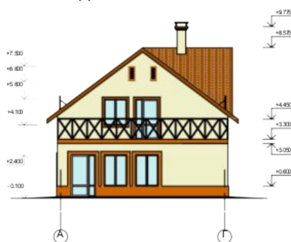
ФАСАД В ОСЯХ А - Г М1:100
