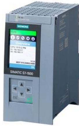
Рисунок 4.2 – Центральний процесорний модуль CPU 1515-2 PN
