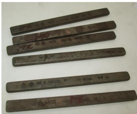
Рис. 2.3. Брусок алмазний хонінгувальний АБХ АС6 160/125 М2-01 100% П 125×12×6 ДСТУ 3292-95
