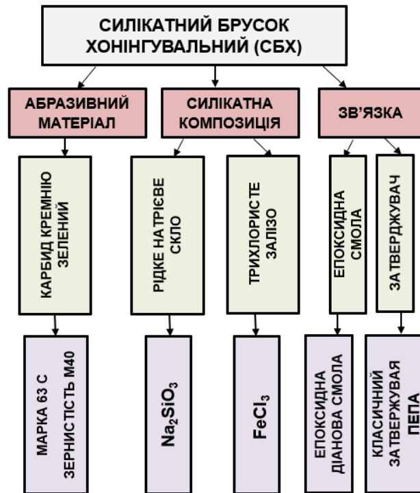
Рис. 3.2. Склад силікатного хонінгувального бруска
