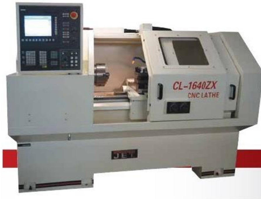
Рис. 3.1 Токарно-гвинторізного верстата з ЧПК CL-1640ZX
