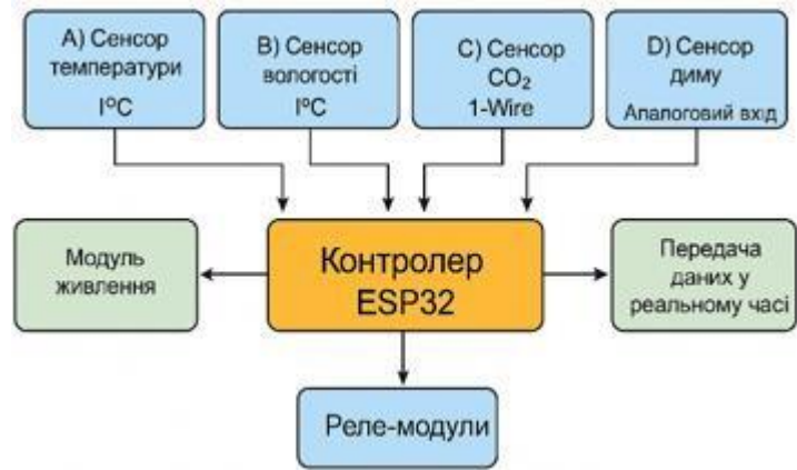
Рисунок 2.3 - Діаграма «Функціональне підключення контролера ESP32»
