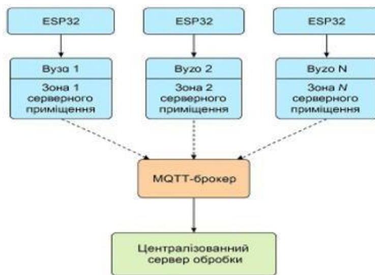
Рисунок 2.7 - Діаграма «Масштабована архітектура системи з кількома ESP32»
