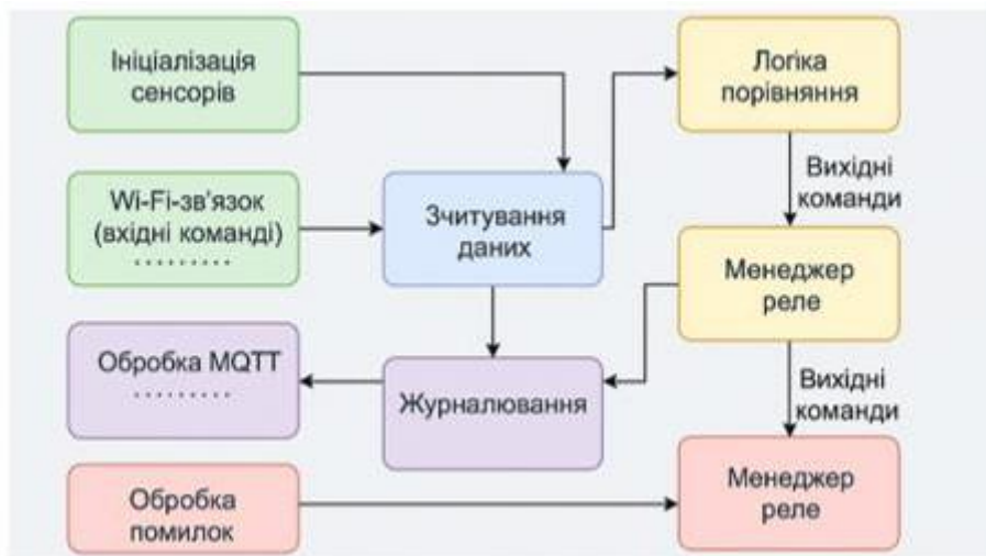
Рисунок 2.15 - Діаграма «Архітектура логічних зв'язків усередині контролера ESP32»
