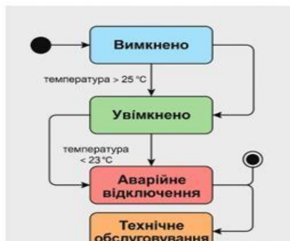
Рисунок. 2.13 - Діаграма «Діаграма станів модуля охолодження»
