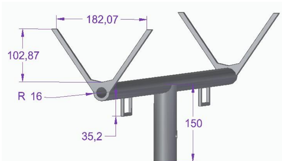
Рисунок 5.2 - Розміри карданних валів та корпусів глушників
