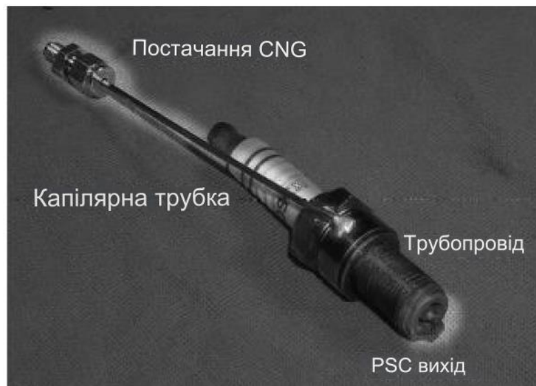
Рис. 1.6. Фото газового інжектора із свічкою запалювання
