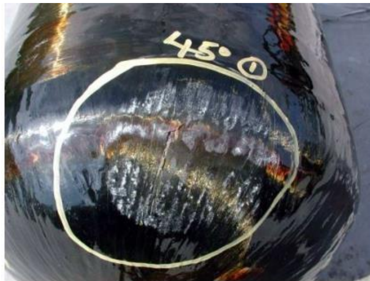
Рис. 7.1. Наслідки ударного випробування композитного балона для СПГ.
