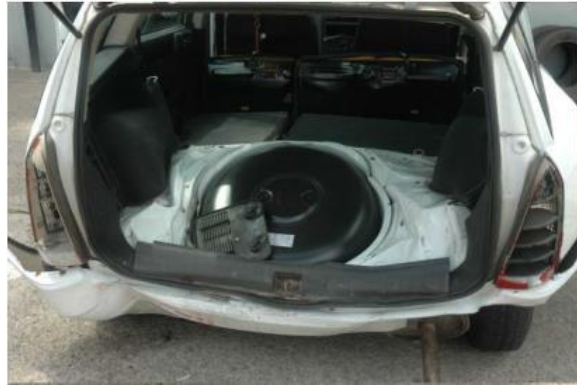
Рис. 7.10. Задня частина автомобіля з тороїдальним балоном СПГ після зіткнення.
