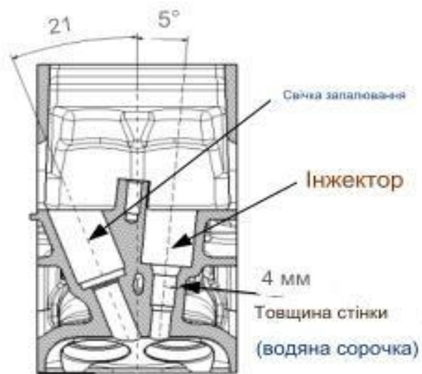
в) поперечний переріз свічки запалювання та інжектора (модифікована модель).
