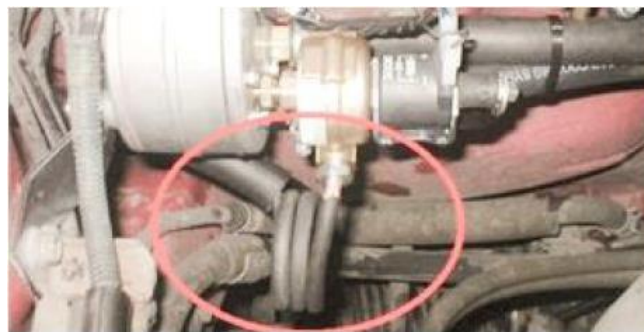
Рис. 7.8. Спосіб підключення випарника до жорсткої мідної трубки СПГ.
