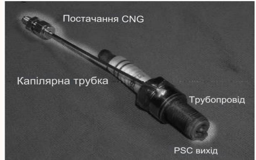
Рис. 4.2. Фото газового інжектора із свічкою запалювання
