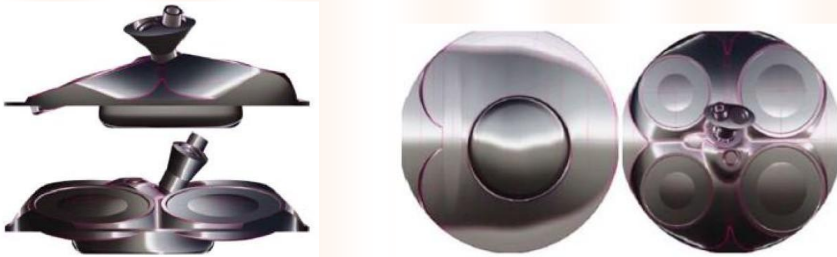
Рис. 8.1. Система згоряння з прямим впорскуванням газу та реактивним запалюванням
