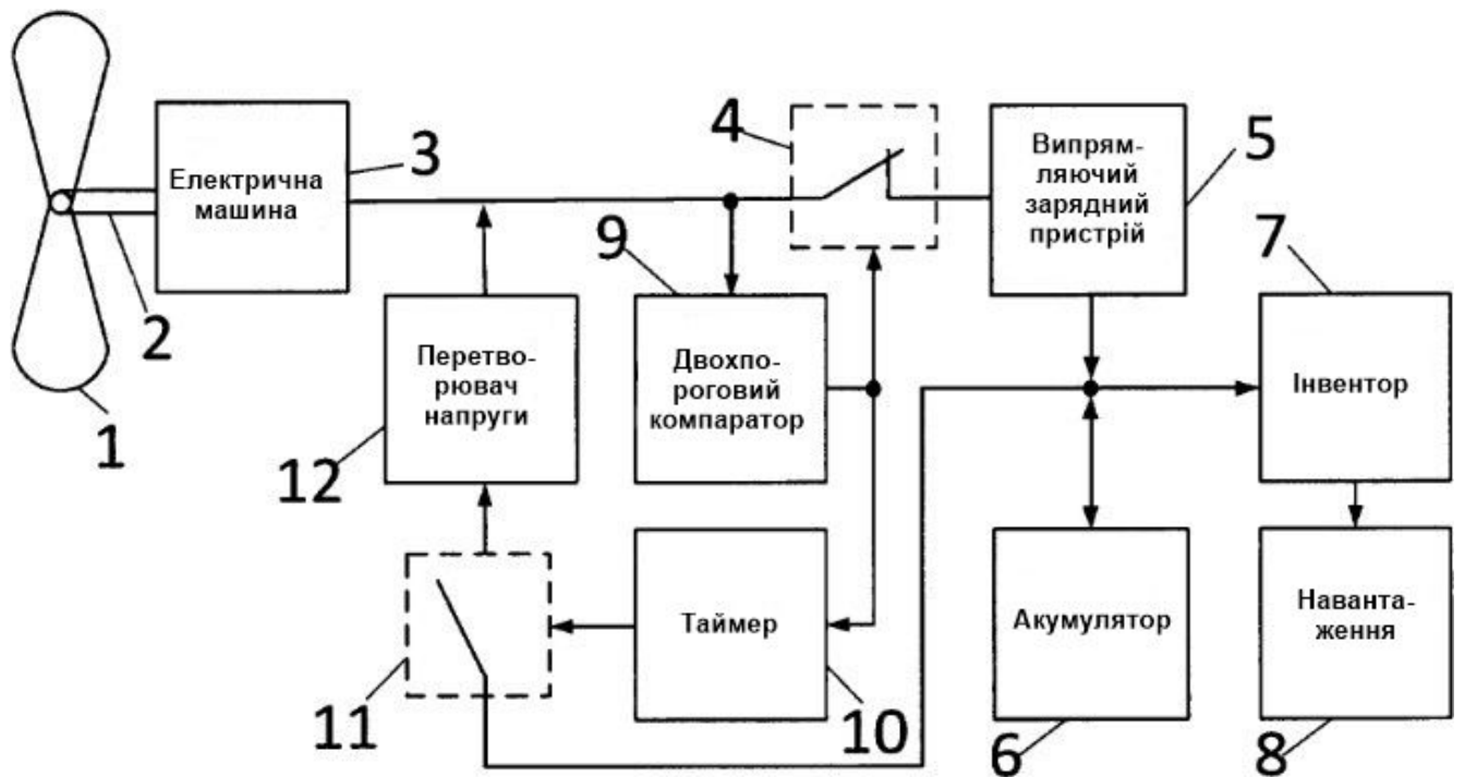
Рисунок 1.4 – Структурна схема вітроенергетичної установки
