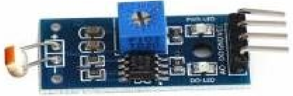
Рисунок 8.3 – Аналогово-цифровий модуль датчика освітленості
