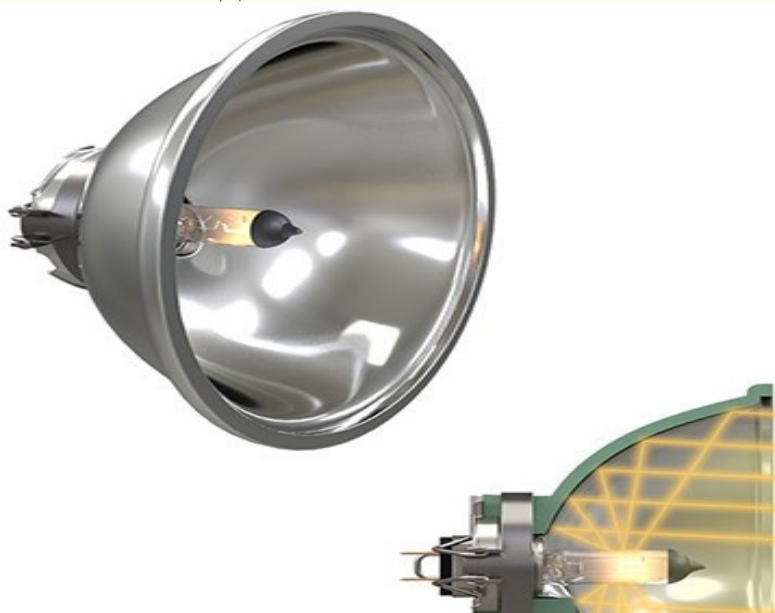
Рисунок 4.2 – Напрямок променів фар ближнього світла
