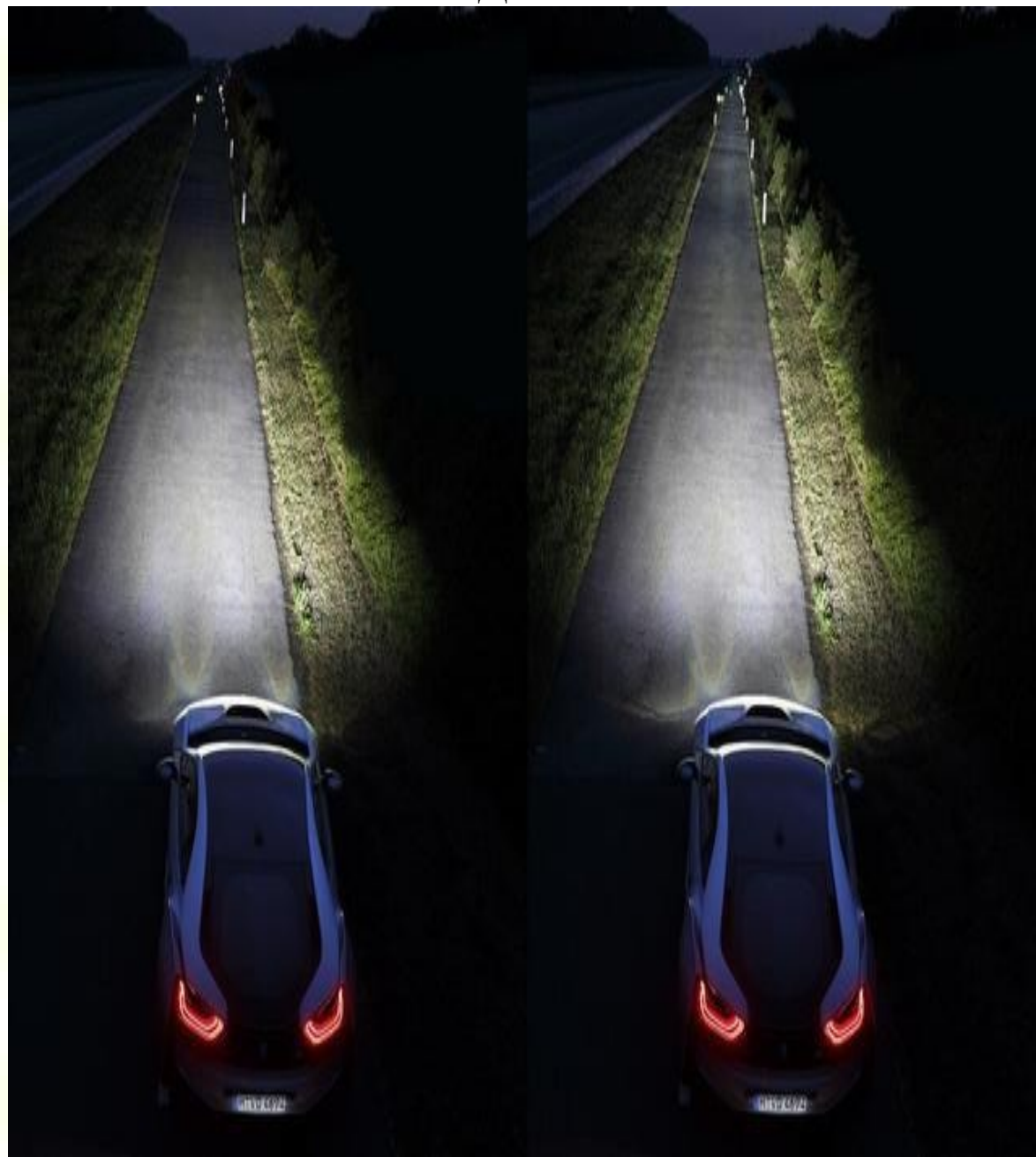
Рисунок 4.3 – Характер освітлення дороги променями фар ближнього і дальнього світла
