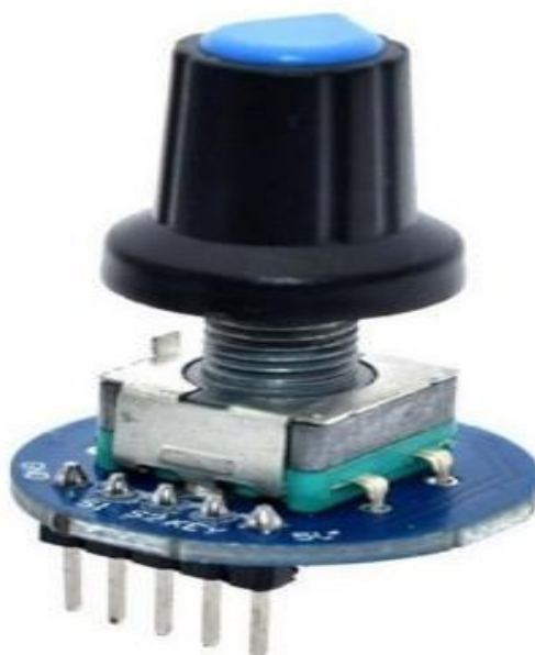
Рисунок 2.17 – Енкодер EC11 з RC-фільтром
