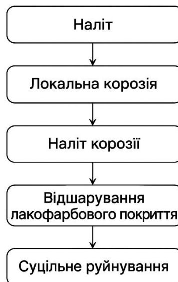
Рисунок 2.1. Блок-схема послідовності розвитку корозії кузова автомобіля
