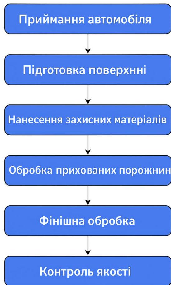
Рисунок 3.1. Схема технологічного процесу дільниці антикорозійного захисту кузова
