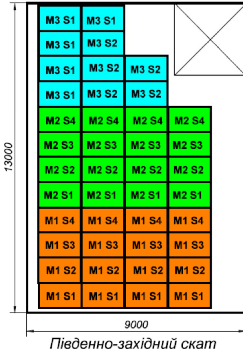
Рисунок 3.12 – Схема з'єднання фотомодулів у стрінги фотомасивів
