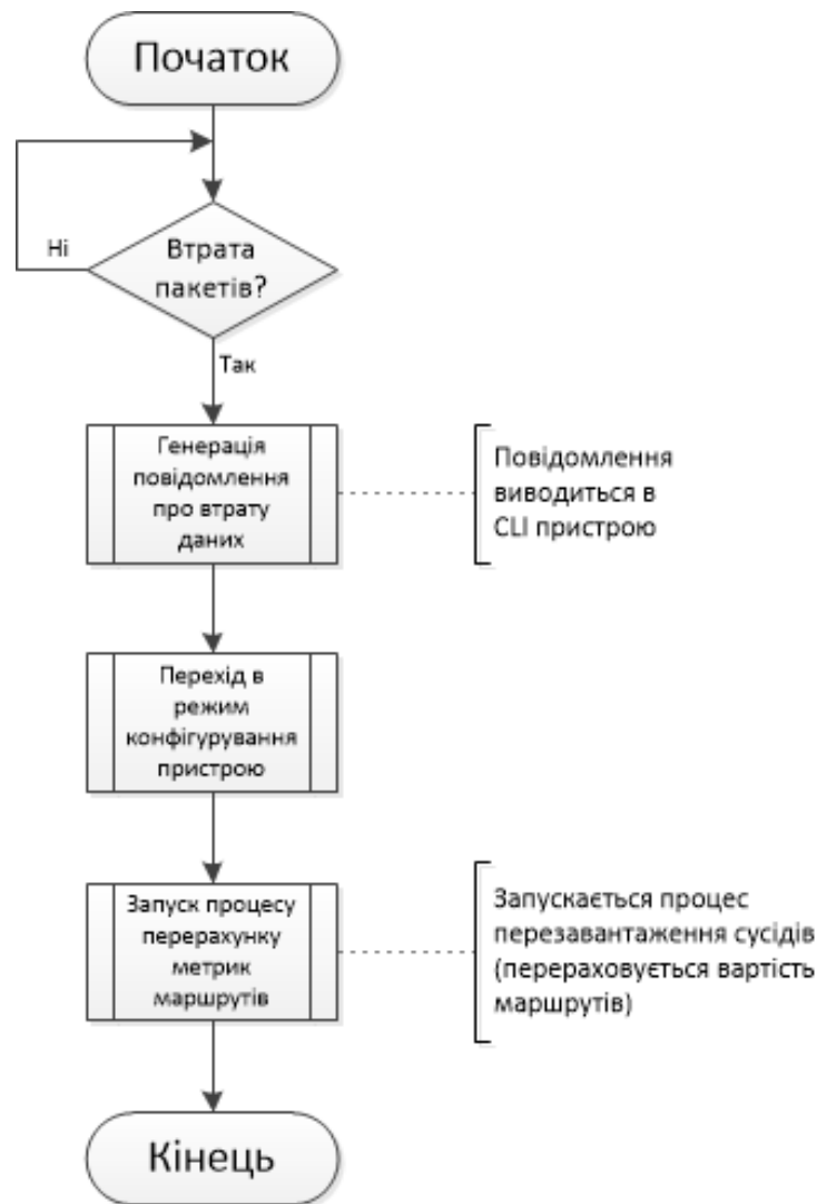
Рисунок 2.7 – Блок-схема алгоритму запобігання втрати пакетів
