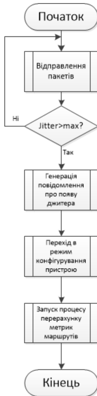
Рисунок 2.8 – Блок схема алгоритму, що визначає затримку
