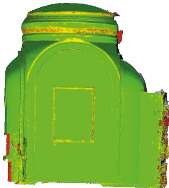
Рисунок 13. Порівняння даних лазера з фотограмметричною моделлю.
