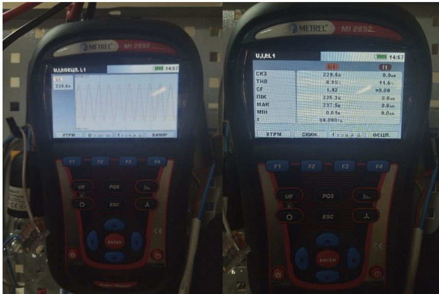
Рисунок 1.12 – Загальний вигляд аналізатора якості електроенергії
