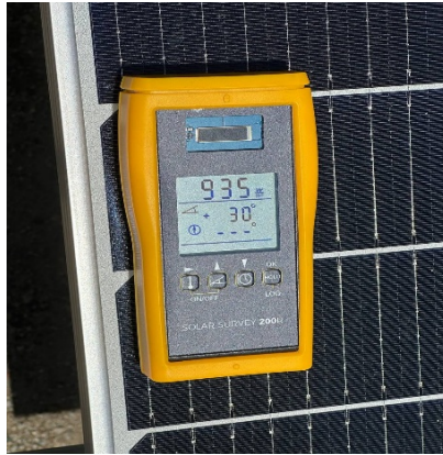
Рисунок 1.15 – Загальний вигляд фотоелектричного вимірювача сонячної радіації
