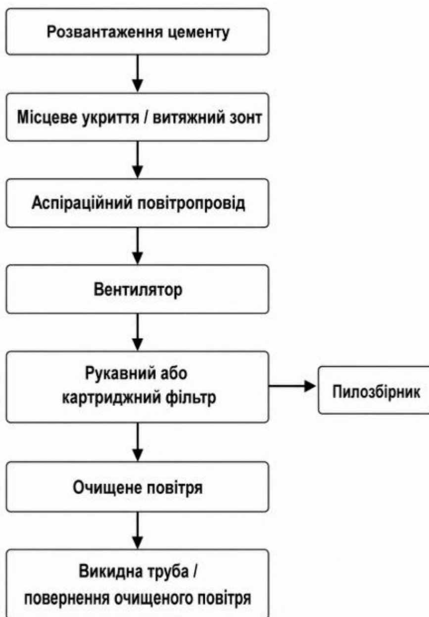
Рисунок 4.1. Принципова технологічна схема очищення пилогазових викидів на підприємстві
