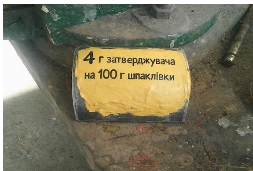
Рисунок 3.3 - Зразок №3 (дозування затверджувача: 4 г / 100 г)
