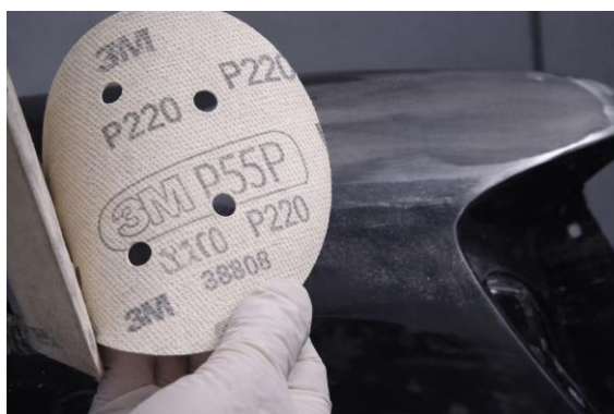
Рисунок 2.6 - Шліфування деталі абразивним диском Р 220.
