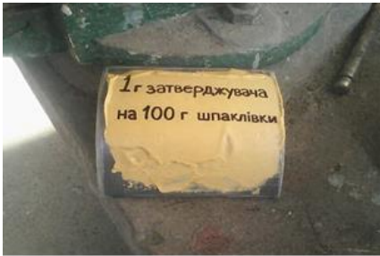
Рисунок 18 - Зразок №1 (дозування затверджувача: 1 г / 100 г)
