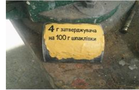
Рисунок 20 - Зразок №3 (дозування затверджувача: 4 г / 100 г)
