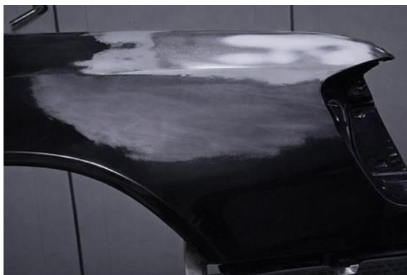
Рисунок 17 - Деталь підготовлена до ґрунтування.
