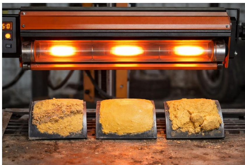
Рисунок 3.4 - три зразки піддаються сушінню за температури 40 °С, при цьому до 100 г шпаклівки додано різну кількість затверджувача (1 г, 2,5 г та 4 г відповідно)
