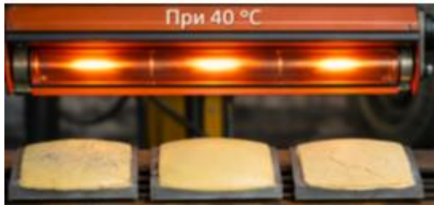
Рисунок 18 - Зразок №1 (дозування затверджувача: 1 г / 100 г)
