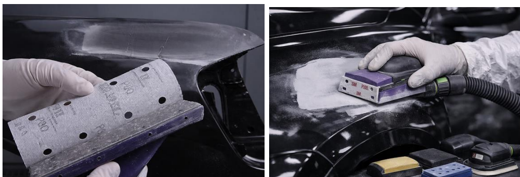
Рисунок 2.5 - Шліфування деталі абразивним листом Р 80.
