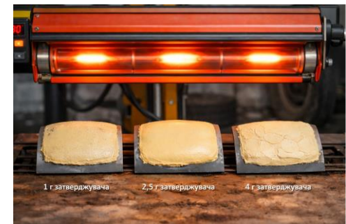
Рисунок 23 - Три зразки піддаються сушінню за температури 80 °C
