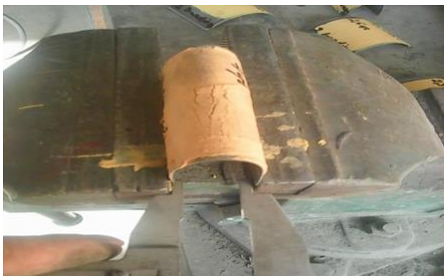
Рисунок 3.22 - Зразок №3 після стиснення до моменту розтріскування шпаклівки вимірний залишок становив 19 мм.
