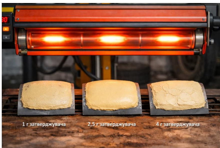
Рисунок 3.8 Три зразки піддаються сушінню за температури 80 °С, при цьому до 100 г шпаклівки додано різну кількість затверджувача (1 г, 2,5 г та 4 г відповідно)
