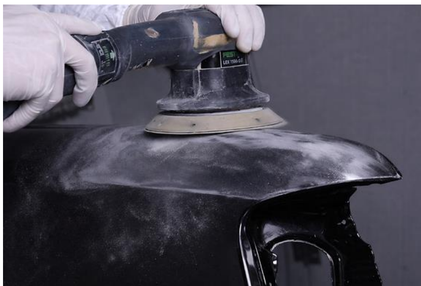
Рисунок 2.1 - Шліфування абразивним диском Р 80.
