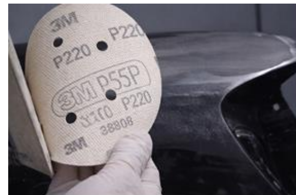
Рисунок 16 - Шліфування деталі абразивним диском Р 220.
