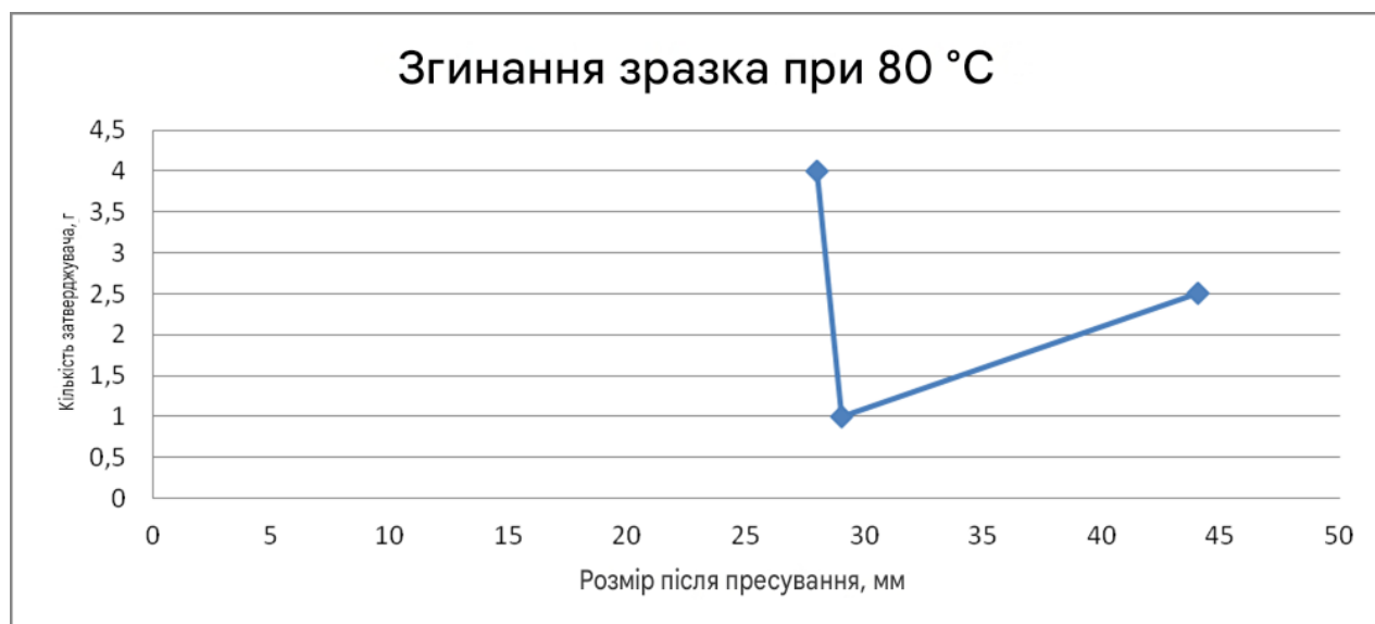
Рисунок 3.30 - Згинання зразка за температури 80 °C
