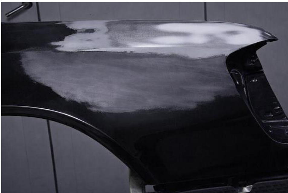
Рисунок 21. Деталь підготовлена до грунтування.
