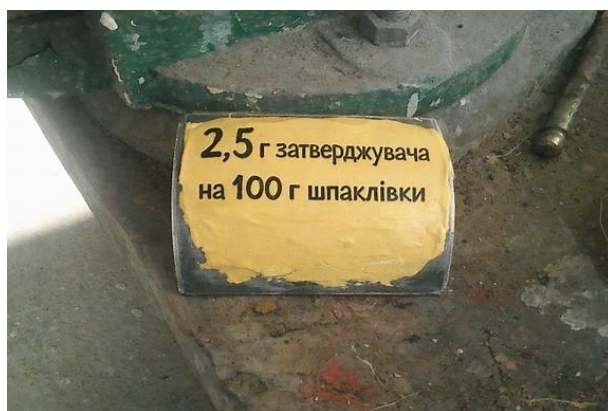
Рисунок 3.2 - Зразок №2 (дозування затверджувача: 2,5 г / 100 г)
