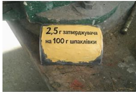
Рисунок 19 - Зразок №2 (дозування затверджувача: 2,5 г / 100 г)
