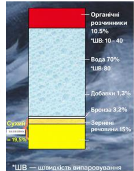
Рисунок 7 - Склад водоемульсійних фарб
