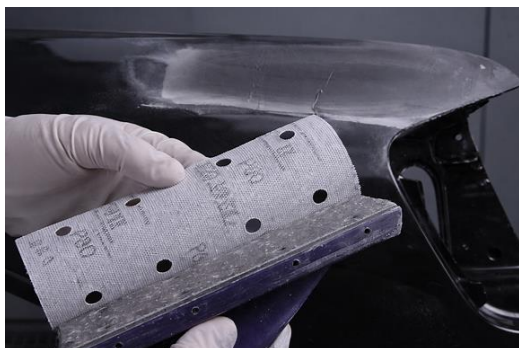
Рисунок 15 - Шліфування деталі абразивним листом Р 80.
