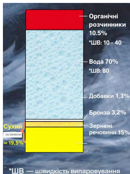
Рисунок 1.7 - Склад водоемульсійних фарб
