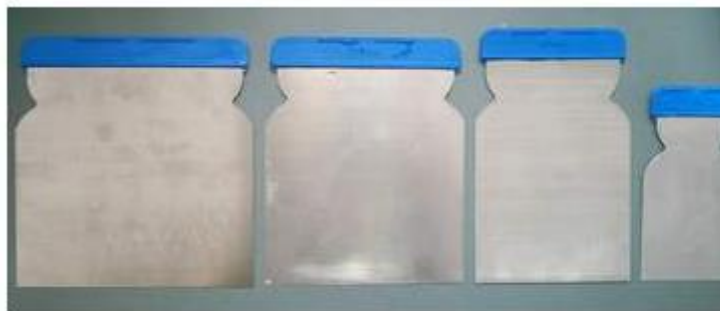
Рисунок 1.10 - Чотири шпателі з нержавіючої сталі для згладжування нерівностей на кузові автомобіля. [6]
