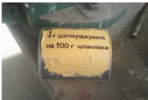
Рисунок 3.1 - Зразок №1 (дозування затверджувача: 1 г / 100 г)
