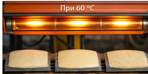
Рисунок 19 - Зразок №2 (дозування затверджувача: 2,5 г / 100 г)
