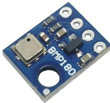
Рисунок 1.3 - сенсор атмосферного тиску BMP180
