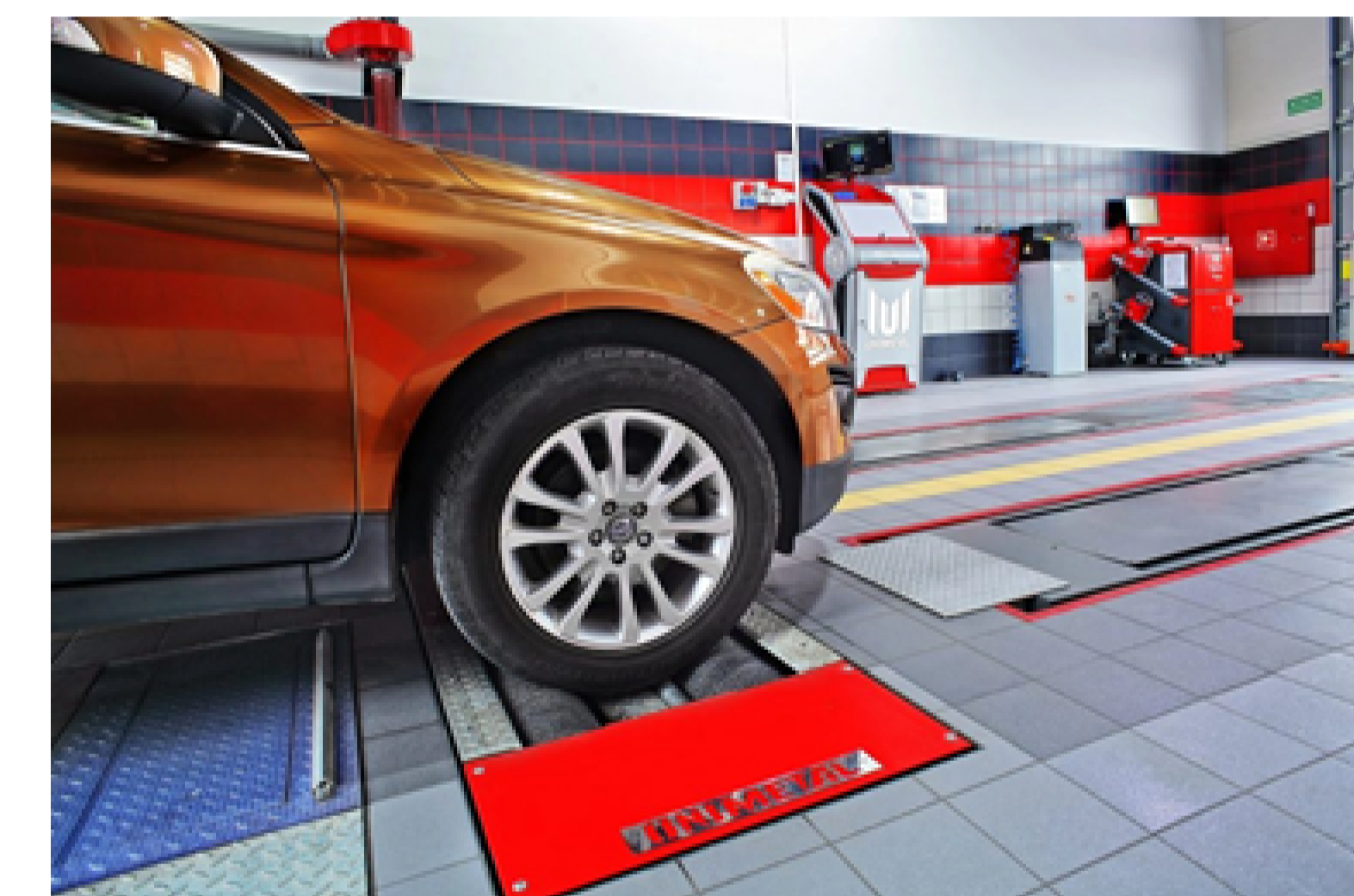
Рисунок 2 - Гальмівний стенд для техогляду легкових автомобілів
