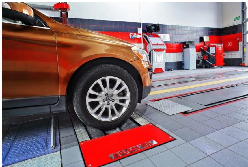
Рисунок 3.10 - Гальмівний стенд для техогляду легкових автомобілів
