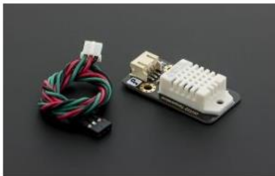
Рисунок 2.3 - Модуль температури та вологості DHT22 та з'єднувальні дроти
