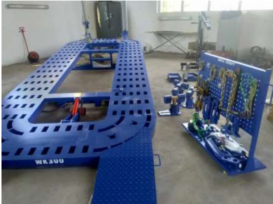
Рисунок 2.1 Платформний стапель для рихтування кузова Well Kraft 300
