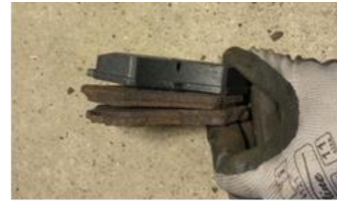
Рисунок 16 - Порівняння зношених гальмівних колодок з новими
