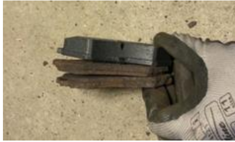
Рисунок 2.5- Порівняння зношених гальмівних колодок з новими
