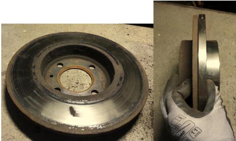
Рисунок 17 - Гальмівні диски: а) зношені гальмівні диски; б) порівняння зношених з новими
