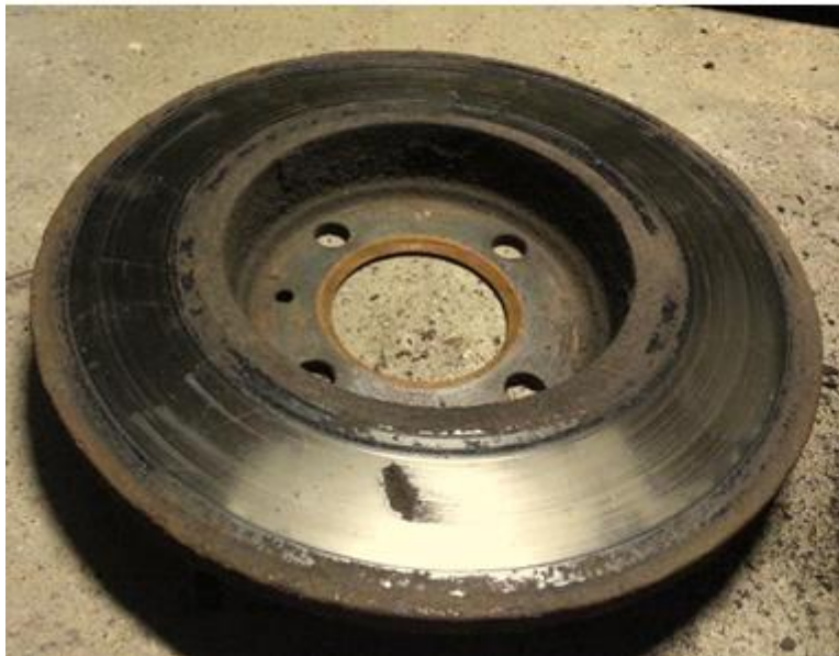
а) б) Рисунок 2.6 - Гальмівні диски: а) зношені гальмівні диски; б) порівняння зношених з новими
