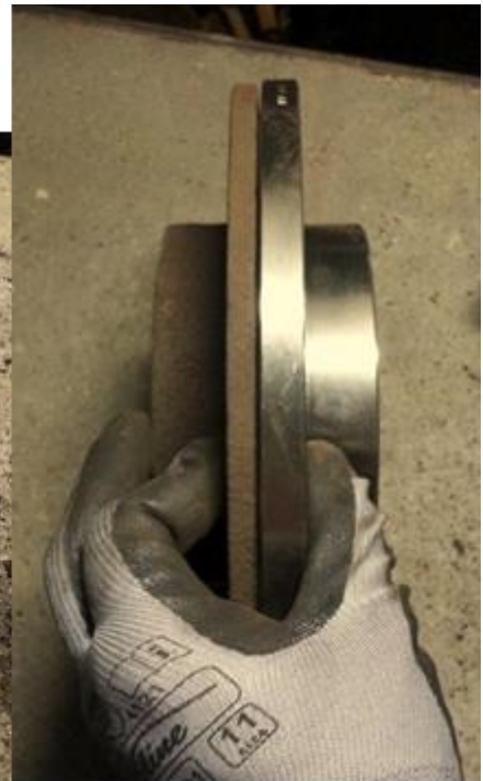
а) б) Рисунок 2.6 - Гальмівні диски: а) зношені гальмівні диски; б) порівняння зношених з новими
