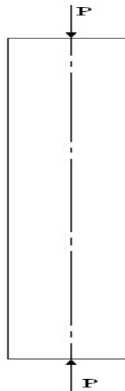
Рисунок 7.2 – Схема дії сил на шток
