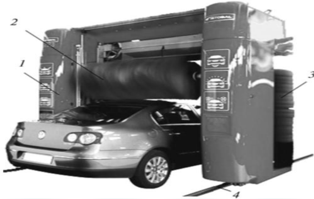
Рисунок 1 – Щіткове портальне миття: 1 - портал; 2 – горизонтальна щітка; 3 – вертикальна щітка; 4 – рейки
