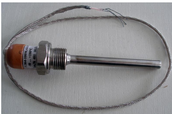
Рис. 5.5. Термоопір типу ТСМ-100М із мідної конструкції
