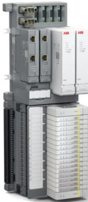
Рисунок 4.9 - Автоматичний регулятор витрати ABB Ability System 800xA з контролером витрати
