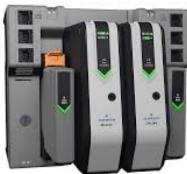
Рисунок 4.14 - Автоматичний регулятор тиску Emerson DeltaV PK Controller з модулем керування тиском
