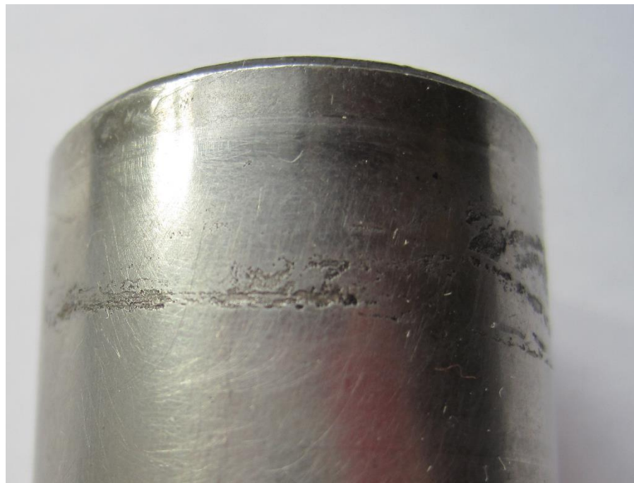
Рисунок 6.4 – Абразивний знос поверхні юбки штовхача
