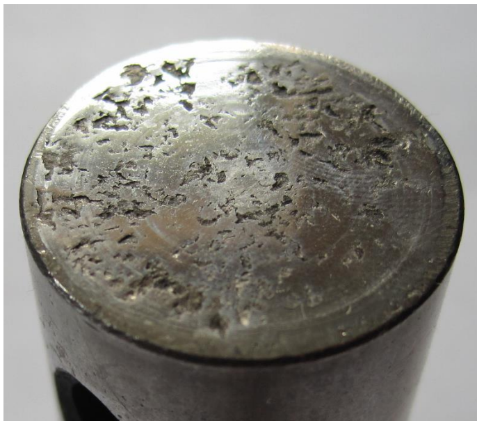
Рисунок 6.5 – Абразивний знос поверхні торця штовхача
