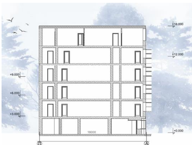
(рис. 2.1.) — у М 1:200, що розкривають внутрішню висоту приміщень, конструкцію перекриттів і даху.
