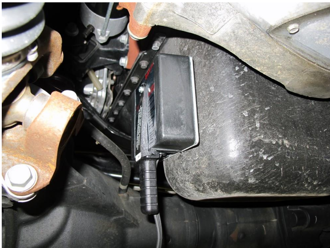
Рисунок 1.3 – Магнітний підігрівач двигуна
