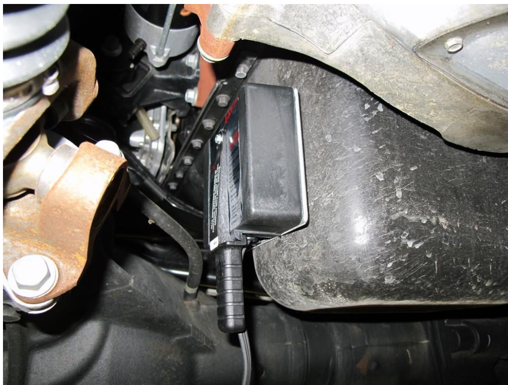
Рисунок 1.3 – Магнітний підігрівач двигуна
