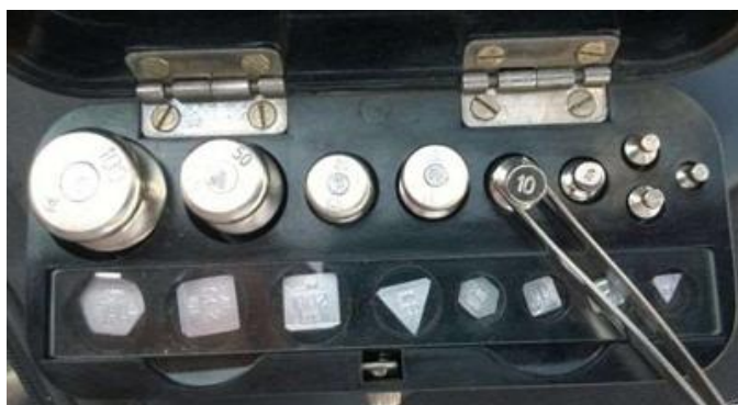
Рис. 2.8. Набір г і мг гирь, розташованих у гніздах пластмасового ящичка [8]
